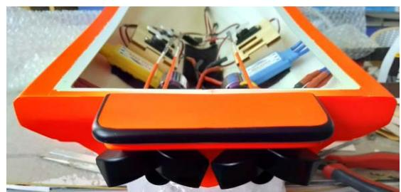
Bevor das Deck (2) aufgeklebt wird, empfiehlt es sich noch, alles für die Befestigung von Fernsteuerung und Akku nach eigenem Ermessen vorzubereiten.
