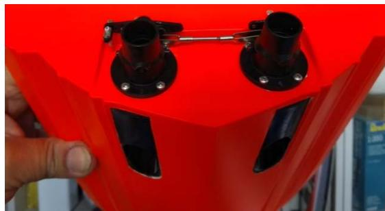
Montez alors les godets inverseurs des jets et raccordez aux deux servos avant. Vérifiez avec soin le fonctionnement de la direction et des godets inverseurs.
