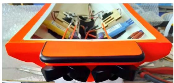
Avant le collage du pont (2), nous vous conseillons de prévoir les supports pour la fixation des accus et de la radiocommande, selon vos idées.
