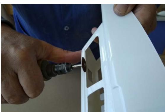
Das Kabinengehäuse (5) wird nun innerhalb der dünnen Fenstermarkierungen ausgebohrt und bis zur Markierung ausgeschnitten und gefeilt.
