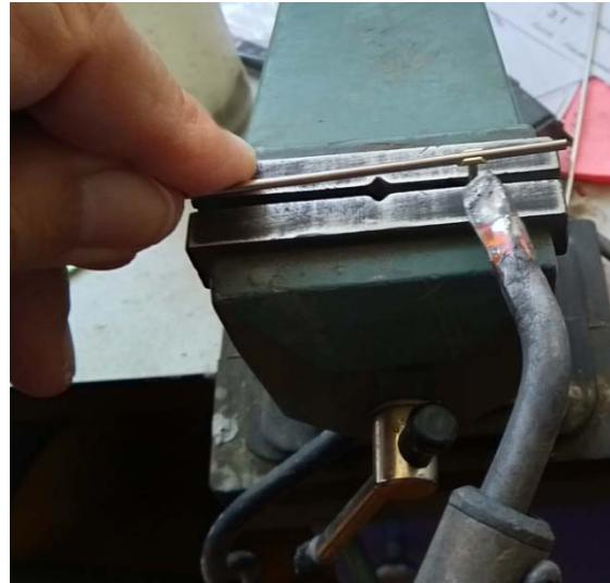
Ajustez alors les deux tubes (40) Ø4x20 mm entre les deux poutres et collez. Pour terminer, assemblez le crochet de treuil avec les pièces (41 à 43) selon le schéma, peignez et montez entre les platines (39). On peut aussi la percer et goupiller.
