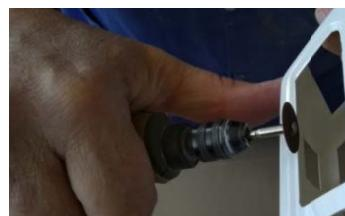
Vue en exemple pour la découpe et la finition avec la mini-tronçonneuse
