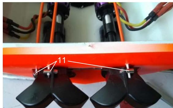
Nun kann die Heckplattform (3) über den Jets angeklebt werden.
