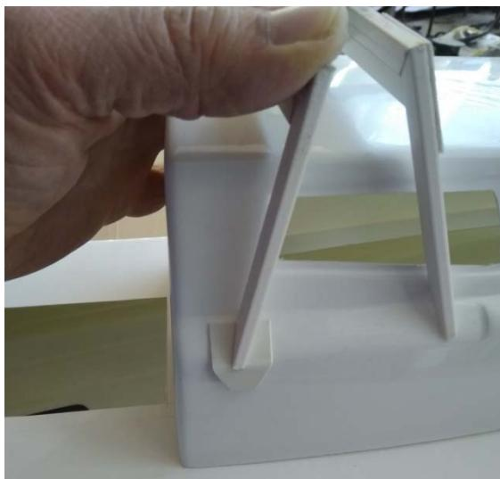
Nun die beiden Rohrstücke (40) Ø4x20 mm zwischen die beiden Kranbalken einpassen und verkleben. Zum Schluss wird der Kranhaken aus den Teilen (41 bis 43) nach Abbildung montiert, lackiert und zwischen den Platten (39) eingesetzt. Diese kann man noch durchbohren und verstiften.
