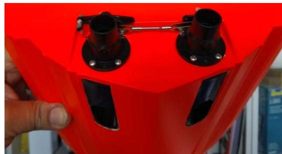
Jetzt auch die Rückwärtsklappen des Jets montieren und an den beiden vorderen Servos anschließen. Überprüfen Sie die Funktion der Lenkung und der Rückwärtsklappen sorgfältig.
