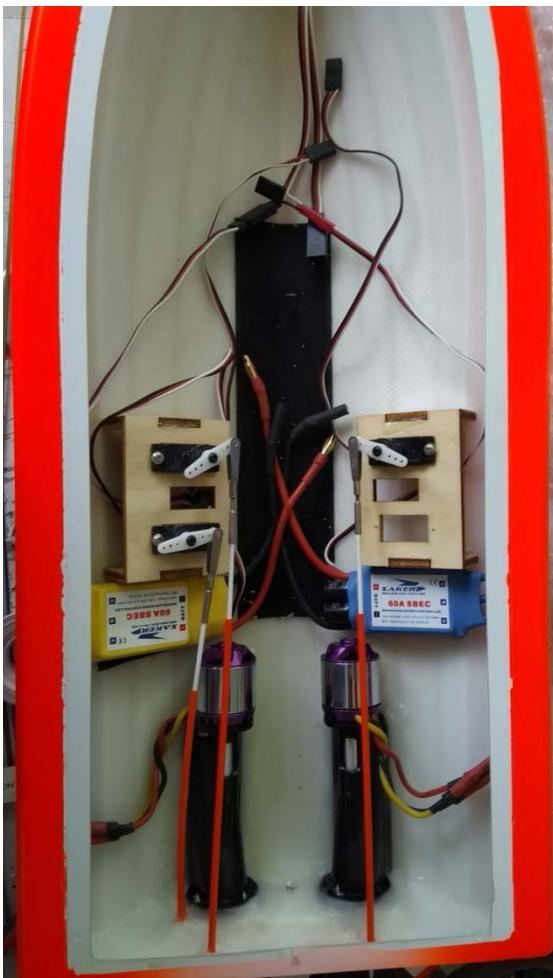
Bereiten Sie nun die Servohalter (6 und 7) und Bowdenzüge (9 und 10) gemäß der Abbildung vor. Montieren Sie die Servos. Ebenso die Verkabelung der Motoren mit den Fahrtreglern.
