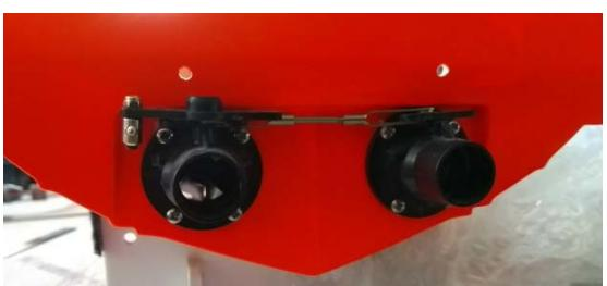
Montez la tringleerie de liaison entre les deux leviers de direction et réglez pour que les jets sortent bien dans l'axe et soient parallèles.
