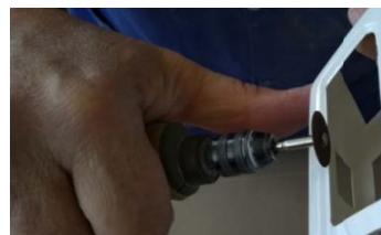
Abbildung beispielhaft für das Herausschneiden und Säubern mit der Trennscheibe
