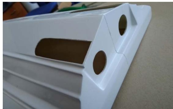
Ajustez les carters des hydrojets avec soin. Lorsque les deux hydrojets sont alignés et parallèles dans la coque, collez-les avec de l'époxy ou Stabilit Express dans la coque de façon étanche sur tout le pourtour.
