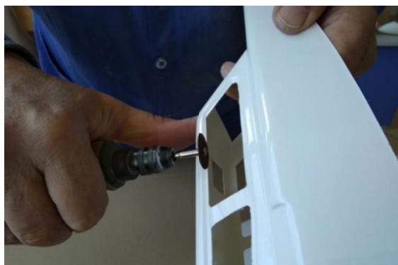
Découpez les ouvertures des vitrages marquées sur la cabine (5) en perçant et limant.
