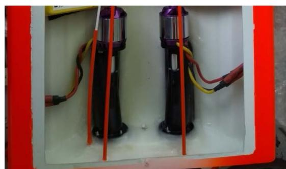
Sodann werden die Wellen mit Kupplungen und den Motoren eingebaut und das Jet-Endstück durch den Rumpf verschraubt.
