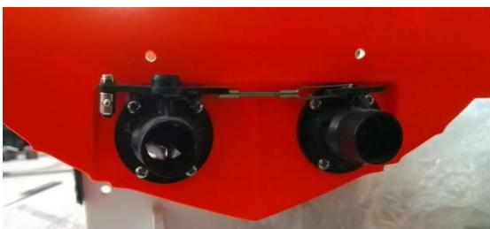
Die Verbindungsstange zwischen den beiden Lenkhebeln montieren und so einstellen, dass die Jets geradeaus genau parallel stehen.
