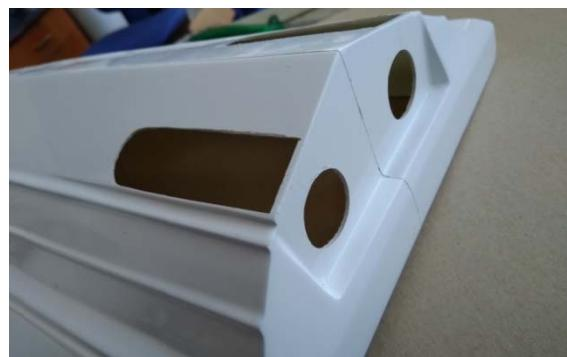
Passen Sie dabei das Jetgehäuse sorgfältig ein. Wenn beide Jets gleichmäßig gerade und parallel im Rumpf sitzen, können die Gehäuse mit Epoxi oder Stabilit Express im Rumpf rund-um dicht verklebt werden.
