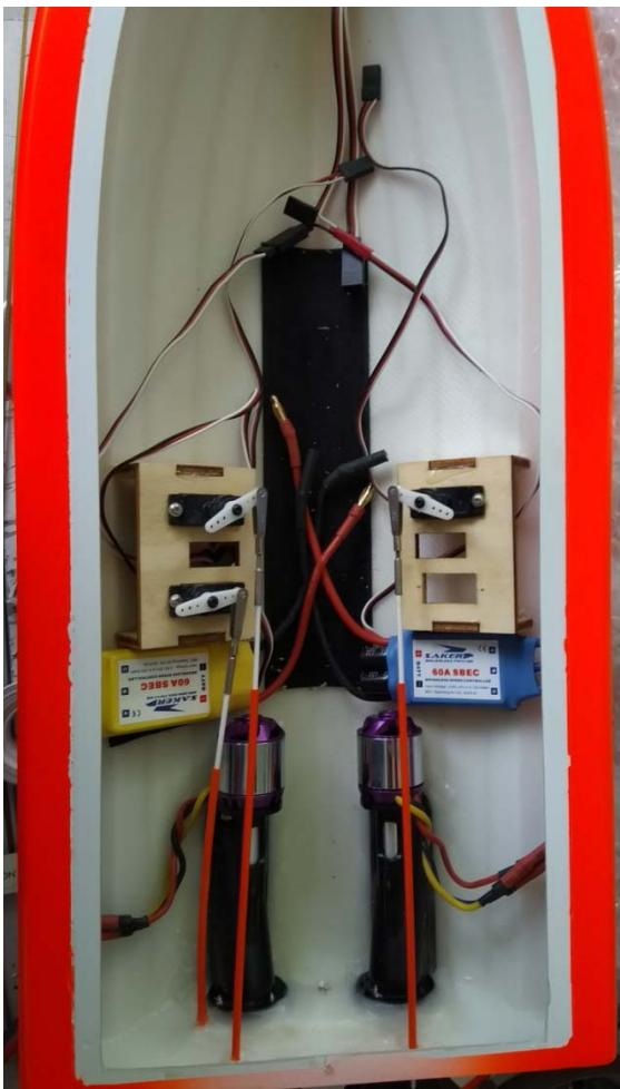
Préparez alors les platines servo (6 et 7) et les gaines de câbles(9 et 10) selon la photo. Montez les servos. Faites également le câblage entre les moteurs et les variateurs.
