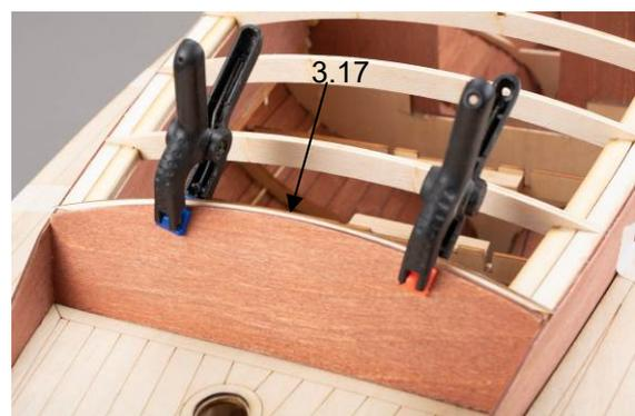
Abb.: Dachspant einkleben
