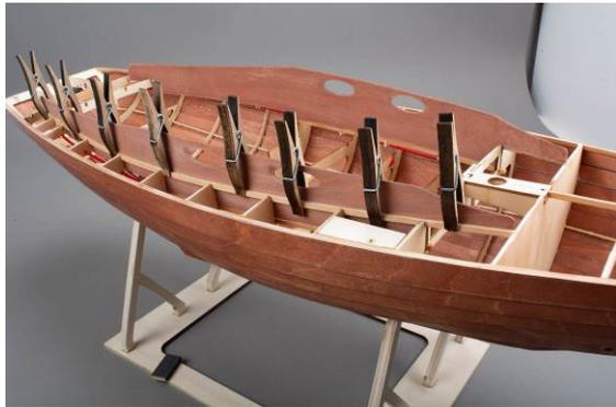
Fig.: Insert body sides
