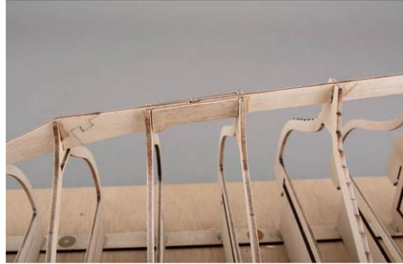
Abb.: Verstärkung Kielbolzen vorne
