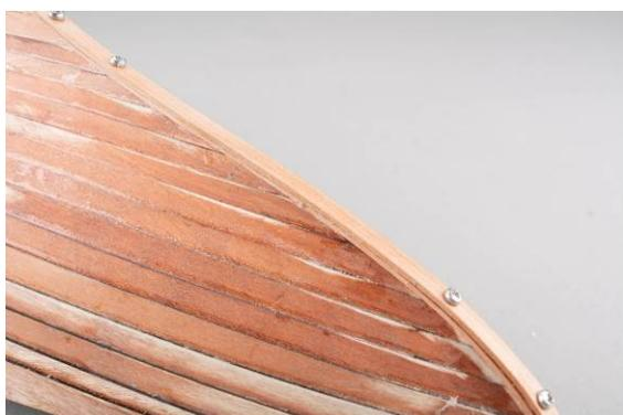
Abb.: Leisten aufgeklebt
