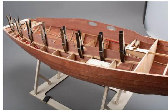
Abb.: Aufbauseiten einsetzen
