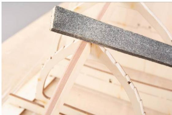
Abb.: Spanten straken
