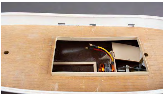
Abb. Speigaten hergestellt und Deck platziert
