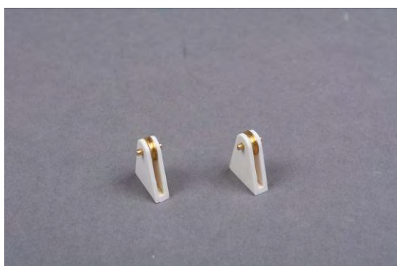
Vue: poulies de renvoi terminées
