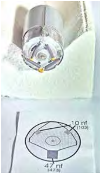
Abb. Motor entstören
