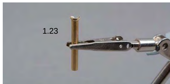
Vue: tube de graissage avec partie arrondie
